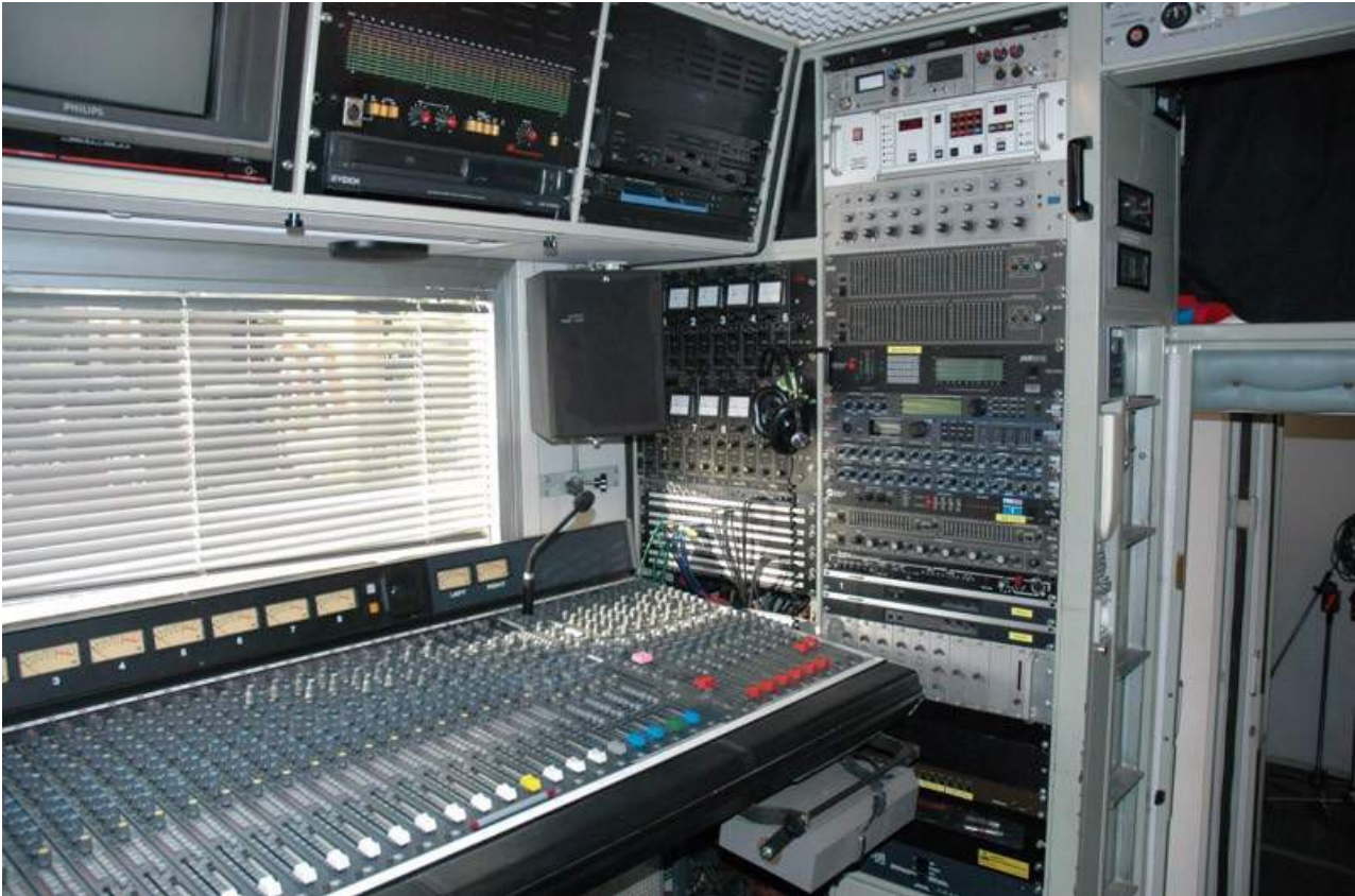
Fig.29 – Attrezzatura per la sala di regia mobile installata in un autocarro da 35 quintali.
