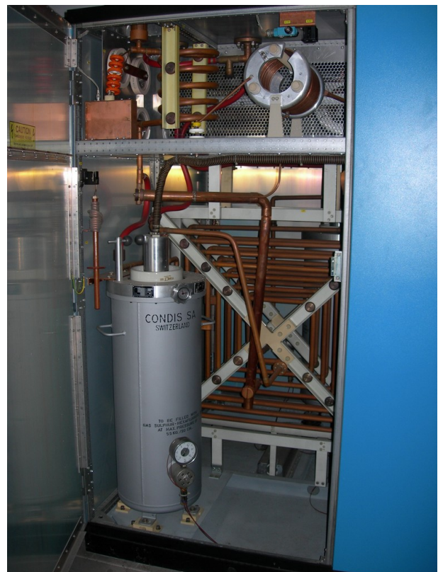
Fig. 8 – Thomcast TMW2600 - Vano tubo RF e vano circuito di accordo anodico
