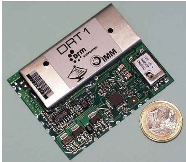
Fig.37 – Scheda ricevitore DRM - DRT1
