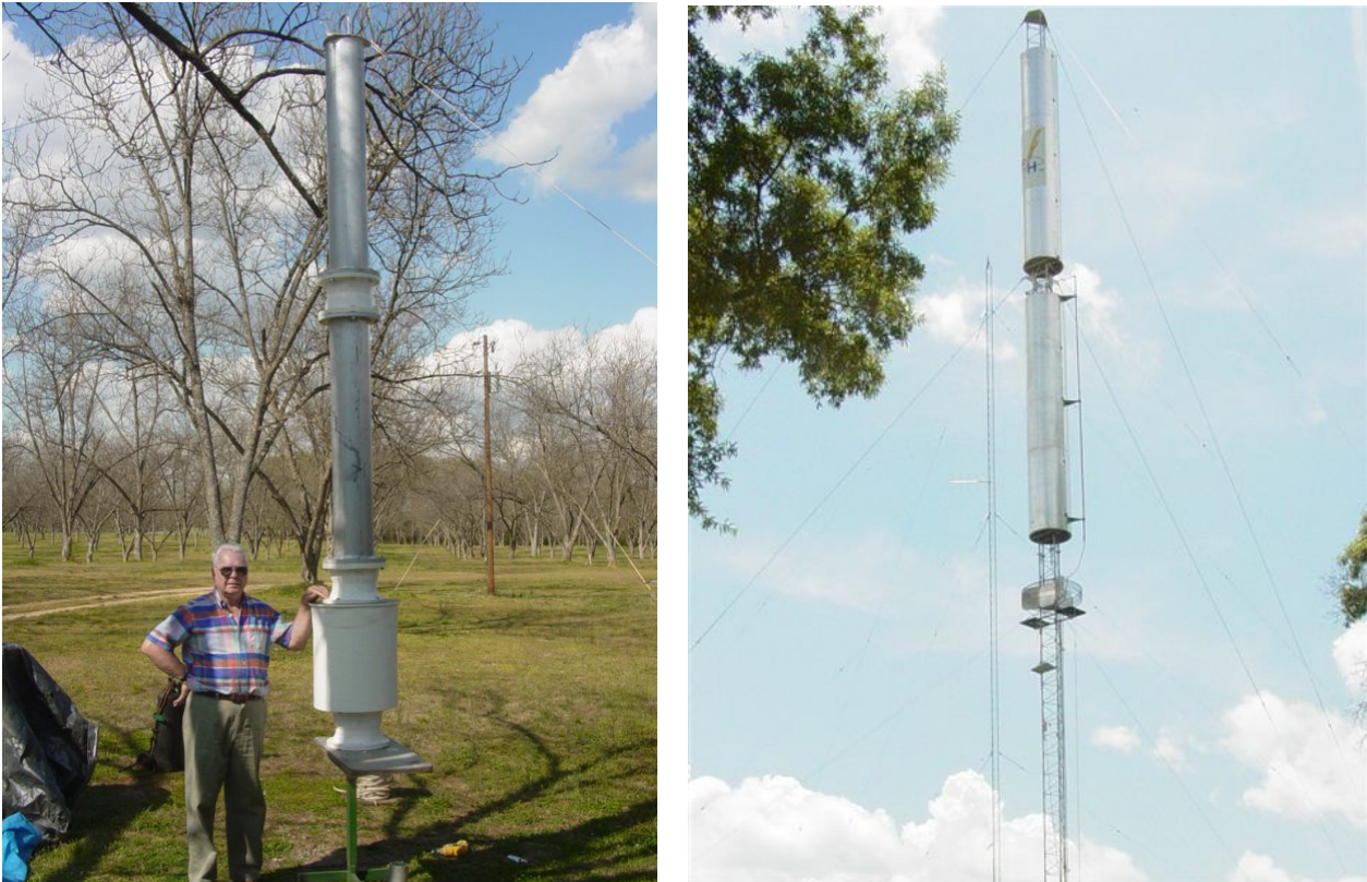
Fig.13 – Antenne EH per uso OM, a sinistra un esempio con supporto in ceramica
